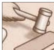
5. Utilizar un rodillo de mano para reafirmar la adhesión. Para el 3M Safety-Walk Conformable, utilizar un mazo de goma para adaptarlo a la superficie irregular.
