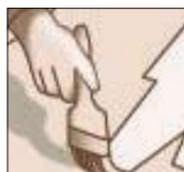
2. En superficies porosas, ásperas o desiguales (madera, cemento o mármol), aplicar previamente una imprimación 3M (Adhesivo 3M™ EC-1357 o Scotch-Grip™ 10 o Scotch-Clad™ 776) con un cepillo en la zona exacta donde se aplicará el Antideslizante. Dejar secar la imprimación.
